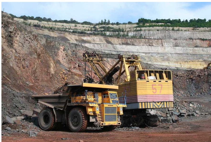
Рис. 4.8. Погрузка горной массы в автомобили БелАЗ (СГОК)
